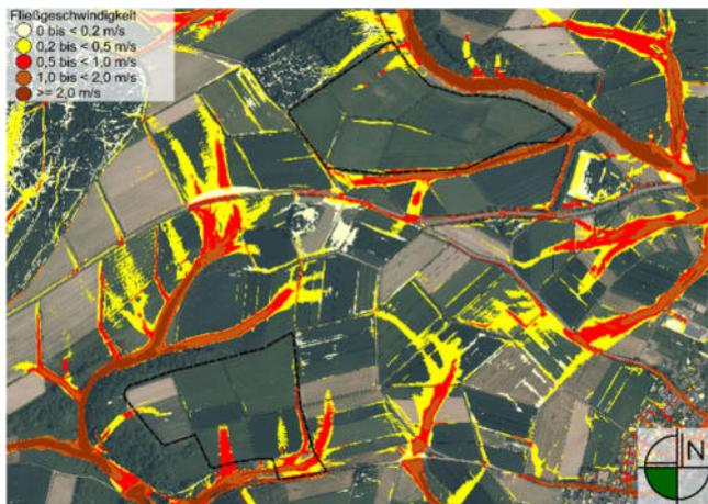
Abbildung 13: Fließgeschwindigkeit bei einem extremen Starkregenereignis mit Kennzeichnung des Plangebiets (GeoBasis-DE 2025).
