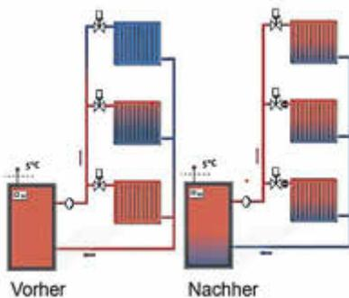
Ein hydraulischer Abgleich stellt sicher, dass jeder Heizkörper genau die nötige Heizwassermenge erhält und eine gleichmäßige Wärmeverteilung im Haus stattfindet.
