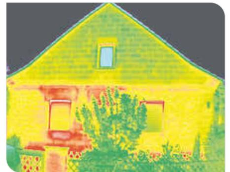
Im Wärmebild lässt sich erkennen, dass über Rolllädenkästen und Fensterbänke der linken Haushälfte viel Wärme nach draußen gelangt (im Bild rot gefärbt).
